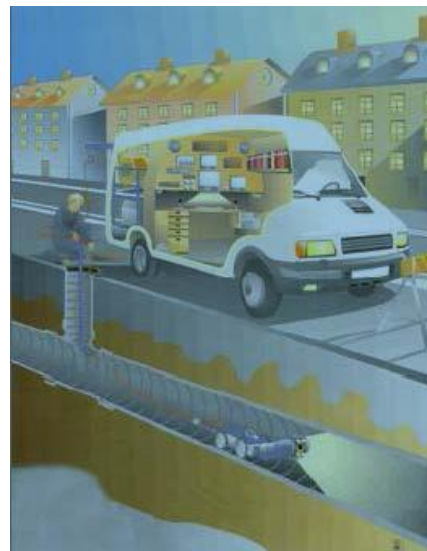
شکل ۶- سیستم دوربینی متداول برای بازرسی سطح داخلی لوله [15]
