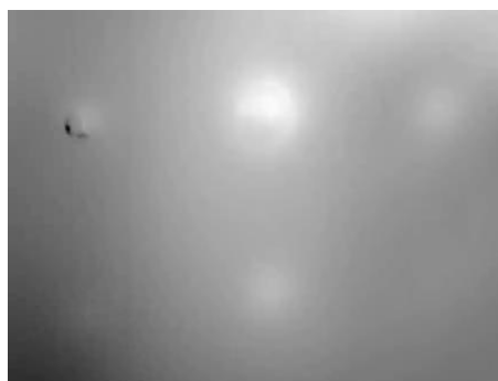
شکل ۵ تصویر فازی عیوب قطعه کار در هنگام گرمایش با دو لامپ از روبرو
