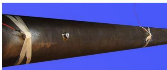
شکل ۲- نحوه قرارگیری سنسورها روی لوله فولادی
