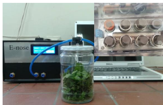
شکل ۲. دستگاه بینی الکترونیک ساخته شده و جعبه حسگرها
