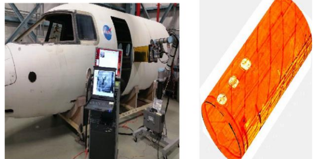
شکل ۳- بکارگیری روش ترموگرافی مادون قرمز جهت ارزیابی عیوب نزدیک به سطح بدنه هواپیما [۴۰]
