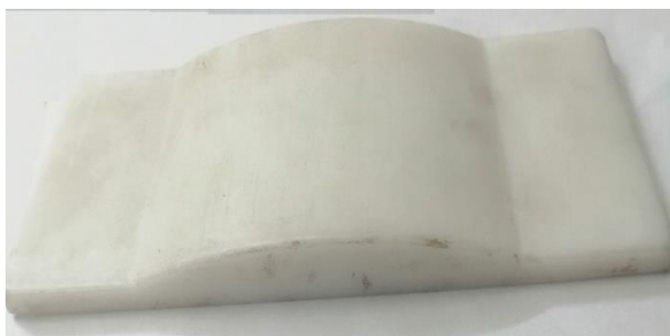
شکل ۱- قالب ساخت نمونه‌های کامپوزیتی
