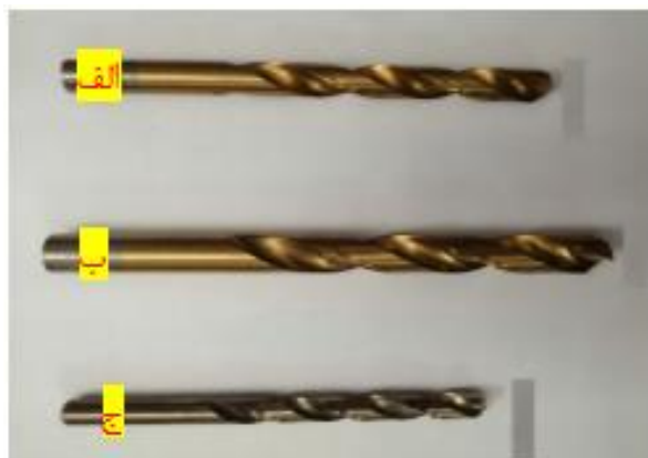
شکل ۳- الف مته با قطر 10mm، ب مته با قطر 12mm، ج مته با قطر 8mm
