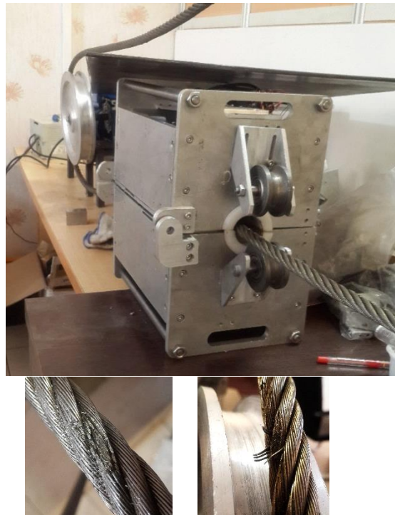
شکل ۱- سامانه آزمون کابل و عیوب آن.
