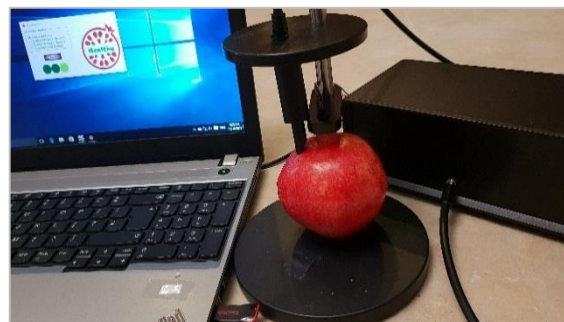
شکل ۶- سامانه اپتیکی تشخیص سریع و غیرمخرب آفت کرم گلوگاه انار مبتنی بر طیف‌سنجی مرئی/فروسرخ نزدیک [۲۷]
