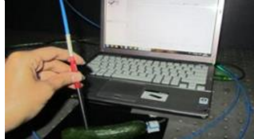
شکل ۵- سامانه اپتیکی تشخیص و تعیین سریع و غیرمخرب باقیمانده سموم در محصول [۱]
