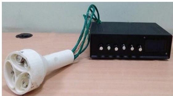
شکل ۷- سامانه هوشمند تعیین غیرمخرب رسیدگی سیب مبتنی بر اطلاعات طیف‌سنجی مرئی/فروسرخ نزدیک [۲۸]
