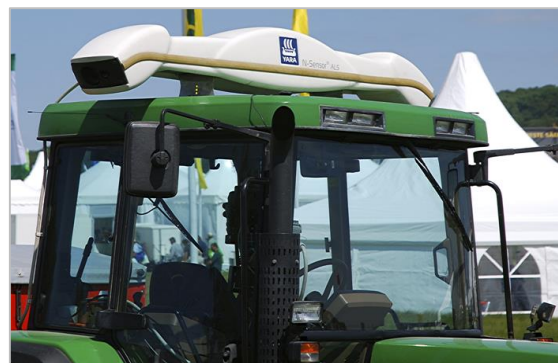
شکل ۴- سامانه هوشمند مبتنی بر طیف‌سنجی برای کیفیت‌سنجی گیاه یا محصول از نظر عناصر تغذیه‌ای و توزیع کود متناسب با نیاز تغذیه‌ای [۴]
