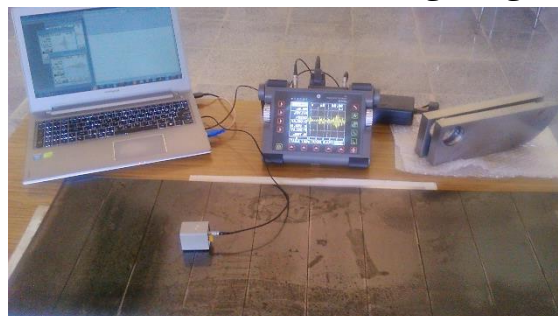
شکل ۴- نحوه قرارگیری پروب زاویه متغیر بر روی سطح ورق فولادی
