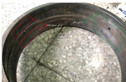
شکل ۹- وضعیت حلقه خارجی یاتاقان پس از تعویض
