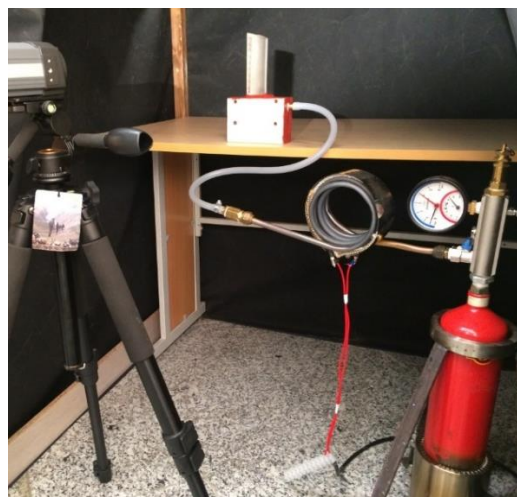
شکل ۲- تجهیزات حرارت دهی و تصویر برداری در آزمایش دمانگاری فعال
