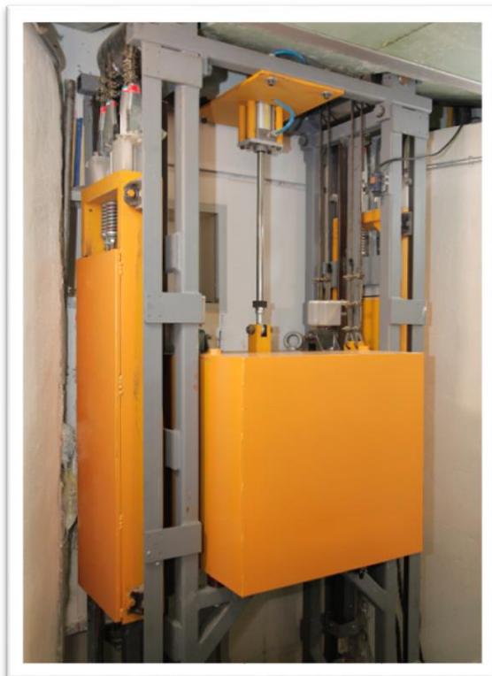
شکل ۶ - نمائی از شاتر بیم نوترونی: طراحی، ساخت و نصب
