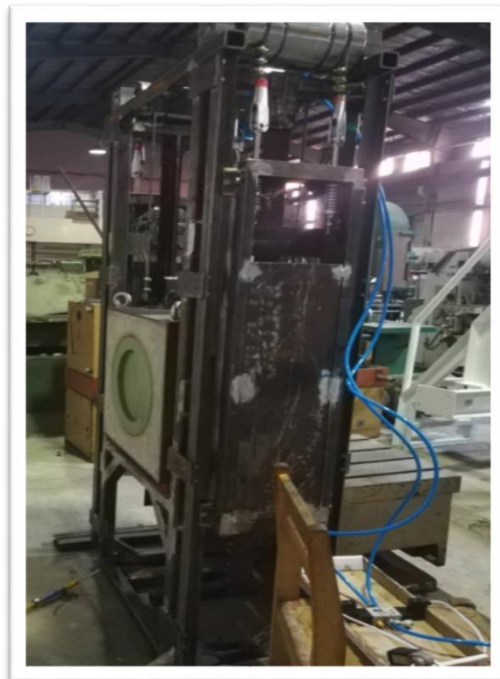
شکل ۶ - نمائی از شاتر بیم نوترونی: طراحی، ساخت و نصب
