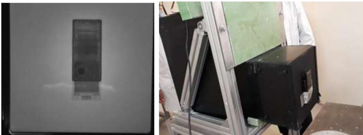
شکل ۱۲ - نمونه‌ای از یک گوشی همراه و تصویر آن که با این سیستم اخذ گردیده است.
