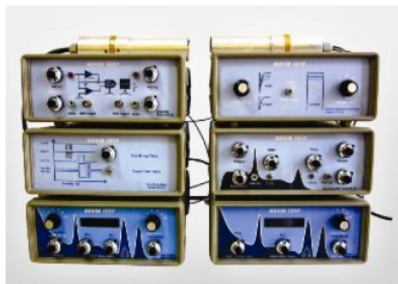
شکل ۴- چینش دستگاه‌ها برای اندازه‌گیری طیف حاصل از نابودی پوزیترون
