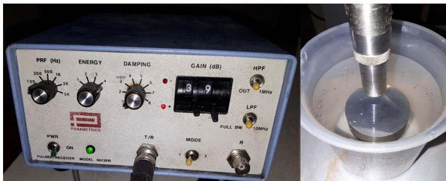
شکل ۱- چگونگی ارسال امواج فراصوتی به درون قطعه استوانه‌ای شکل و تنظیمات دستگاه اندازه‌گیری
