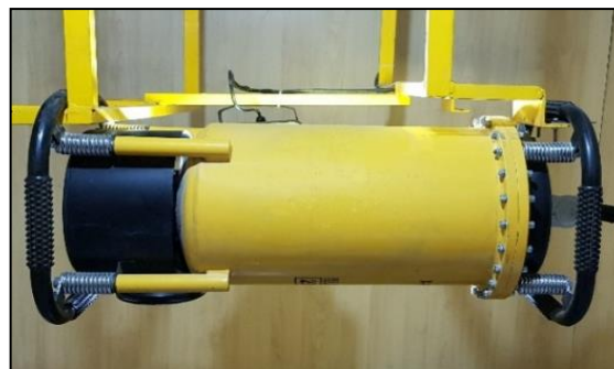
شکل ۲- دستگاه رادیوگرافی صنعتی 250 KV
