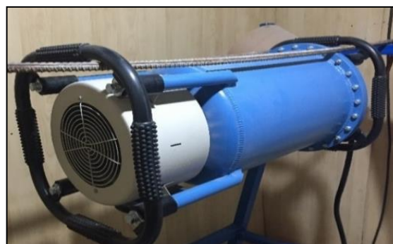
شکل ۳- دستگاه رادیوگرافی صنعتی 300 KV
