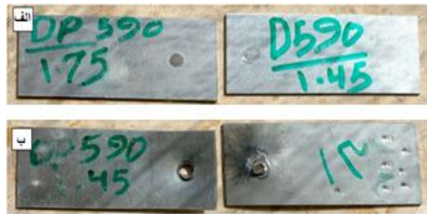
شکل ۵- حالت‌های شکست جوش مقاومتی نقطه‌ای فولاد DP590، (الف) گسیختگی در محل جوش، (ب) گسیختگی در ورق
