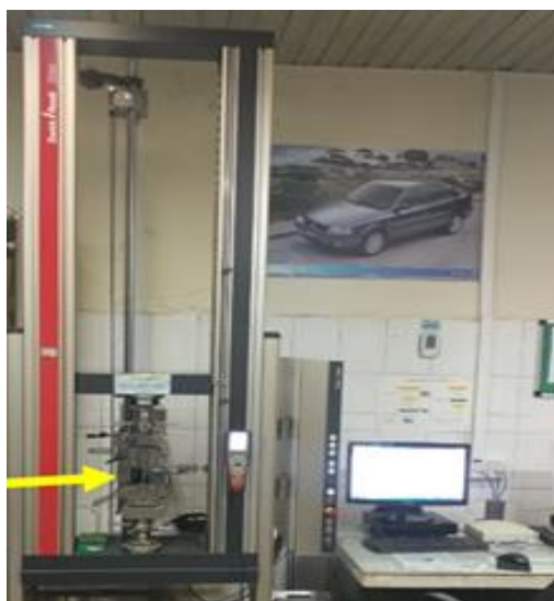
شکل ۴- دستگاه تست کشش-برش مورد استفاده در آزمایش
