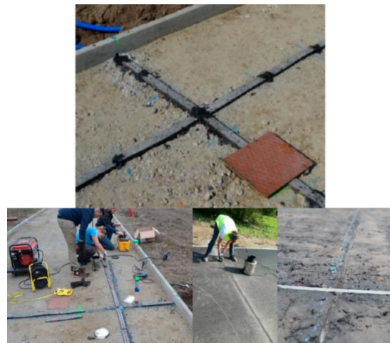
شکل ۶- سیستم پایش حسگرهای FBG پروژه Uantwerp [44]
