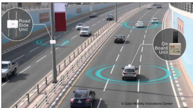
شکل (۷): استقرار واحدهای کنار جاده ای ۲ و واحدهای سواربران ۳ در دوحه، قطر، برای فعالسازی آزمایش ارتباطات وسیله نقلیه به واحد کنار جاده وسیله نقلیه به وسیله نقلیه
