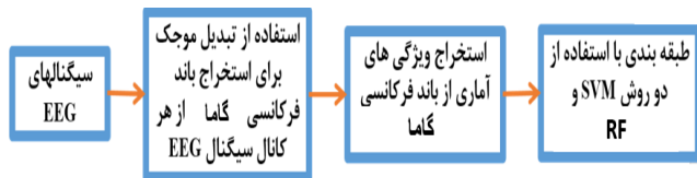
شکل (۱). بلوک دیاگرام روش مورد استفاده توسط کوآر و همکارانش
