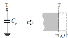
شکل (۷): اتصال انتها باز و مدار معادل آن [۱۰]
