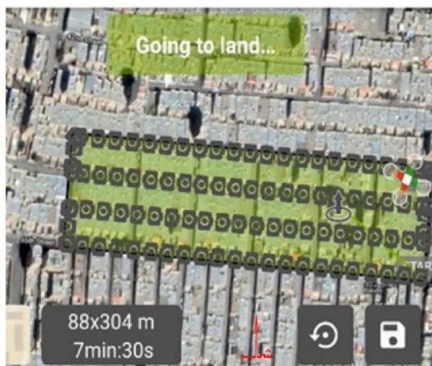
شکل ۳. نمایش پوشش منطقه توسط نوارهای پرواز
