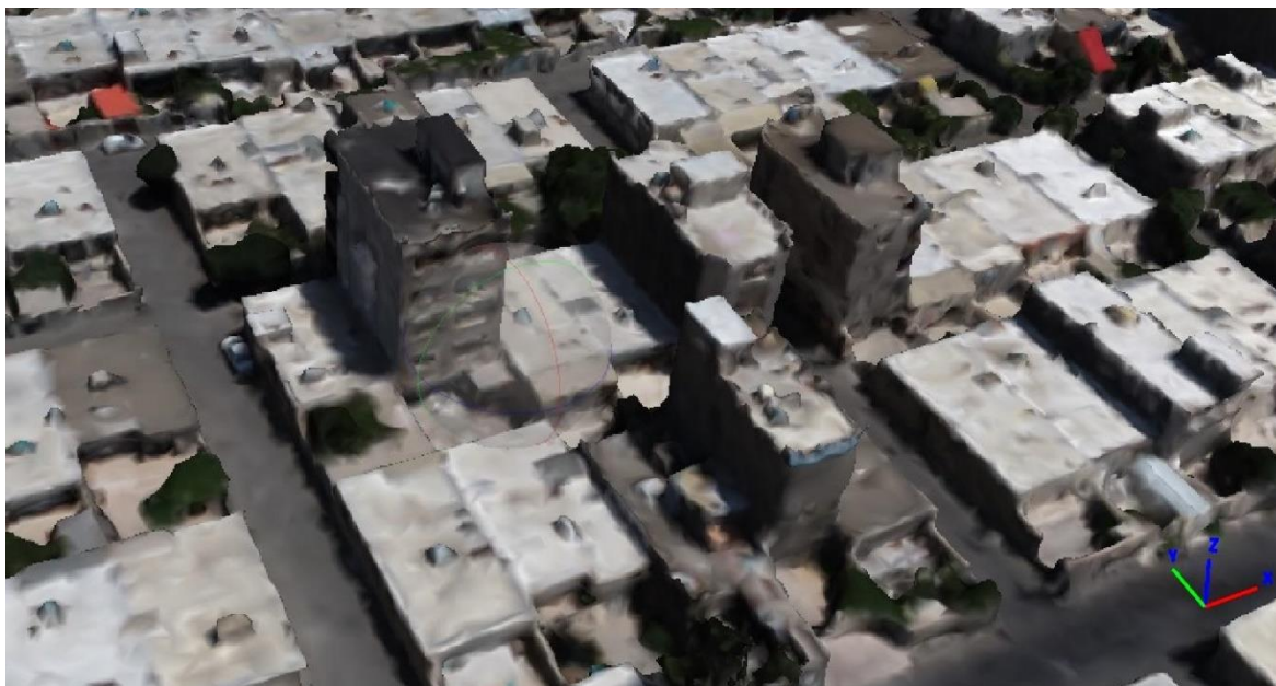
شکل ۶. MESH یا مدل سه بعدی ساخته شده از ابر نقاط متراکم مربوط به منطقه تحقیق
