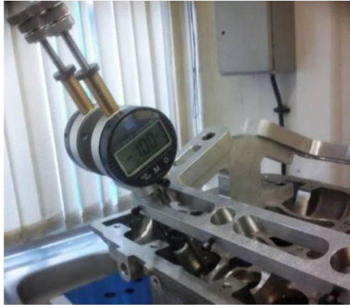
شکل ۵. تنظیم گشودگی سوپاپ با فید مخصوص و ساعت اندازه گیر
