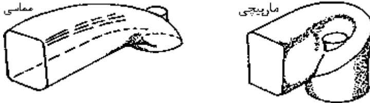
شکل ۲. روش‌های اساسی برای به وجود آوردن جریان گردابه [۱۵]
