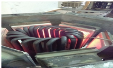
شکل ۲۳. مشعل گرمایی موتور استرلینگ و سنسور اندازه‌گیری دمای موتور گرم
