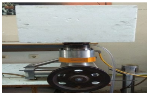
شکل ۱۱. موتور استرلینگ گاما نوع ST500 با عایق جهت تولید سرمایه‌ش
