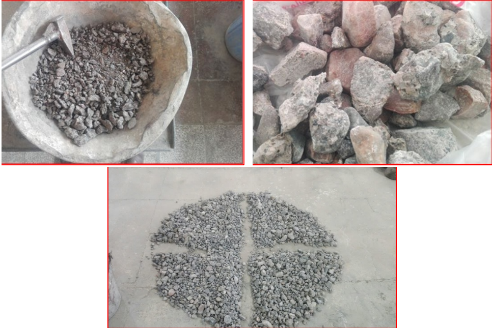
شکل ۱. خرد شدن بتن بازیافتی به عنوان سنگدانه بازیافتی
