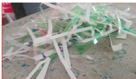
شکل ۳. مواد دورریز پلیاستیکی برای استفاده در بتن بازیافتی
