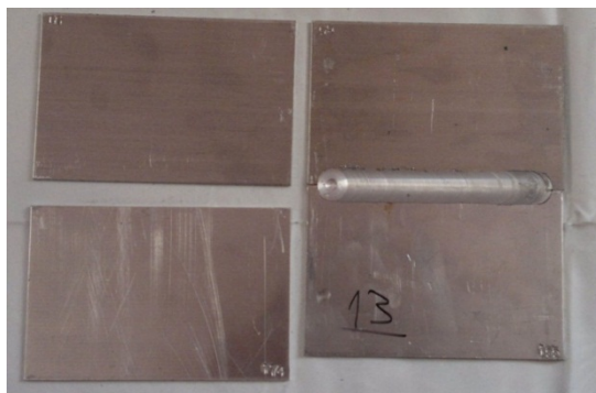
شکل ۴. نمونه‌های قبل و بعد از انجام عملیات جوشکاری با ابزار مربعی
