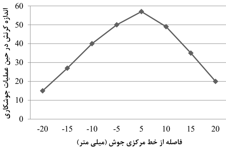
شکل ۳۸. کرنش ایجادشده در قطعه حین عملیات بر حسب فاصله از خط مرکزی جوش
