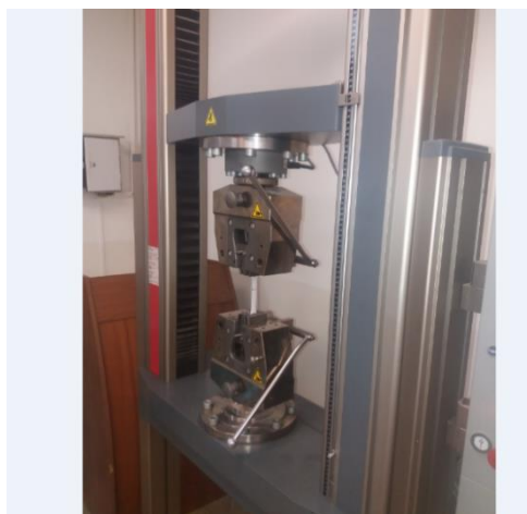
شکل ۵. دستگاه آزمون کشش و فشار
