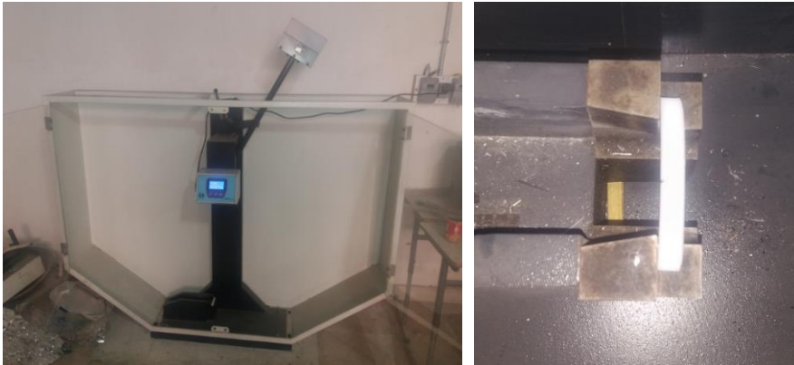
شکل ۱۳. دستگاه آزمون ضربه
