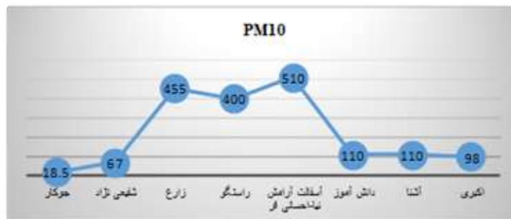
شکل ۵_ مقدار فاکتور ۱۰ میکروگرم بر متر مکعب در محیط بعضی از سنگ شکن‌ها (آزمایشگاه محیط زیست شهرستان بویراحمد، ۱۳۹۶)
