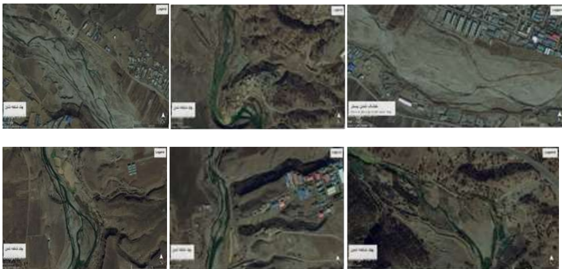
شکل ۷- خشک شدن بستر و چند شاخه شدن جریان آب در اثر تخریب مسیر اصلی رودخانه‌ی بشار
