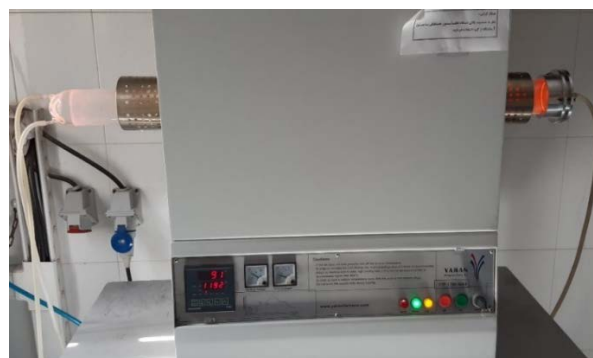
شکل ۴. کوره مدل یاران تحت گاز آرگون
