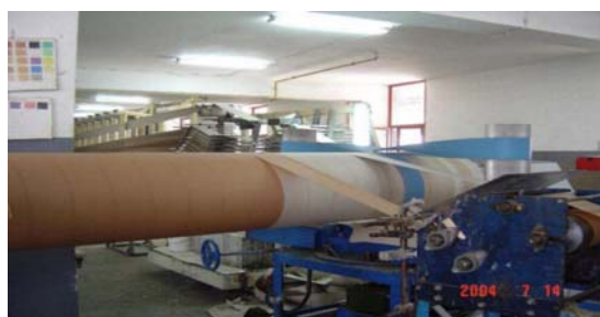
ت ۲" دستگاه تبدیل ورق کاغذ به لوله‌های کاغذی
