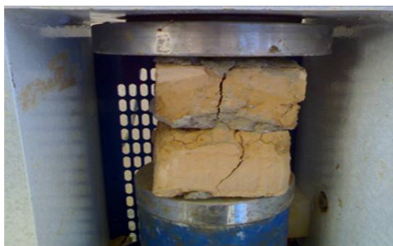
ت ۶. آزمایش مقاومت فشاری.
