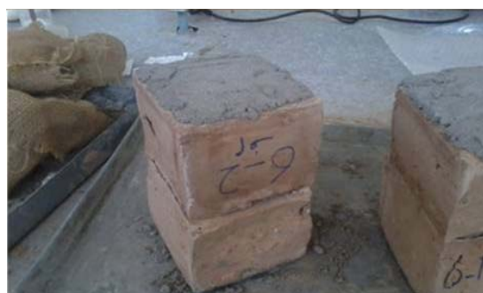
ت ۵. نحوه آماده کردن نمونه برای آزمایش مقاومت.
