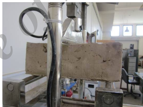
ت ۷. آزمایش مقاومت خمشی خشت.
