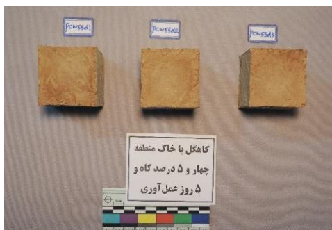
ت ۱۲. نمونه‌های کاهگل مکعبی برای تعیین مقاومت فشاری. مأخذ: نگارنده.
