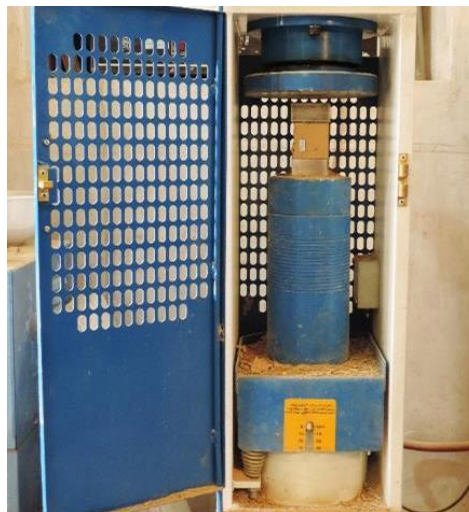
ت ۱۴. اندازه‌گیری مقاومت فشاری نمونه‌های کاهگل مکعبی. مأخذ: نگارنده.
