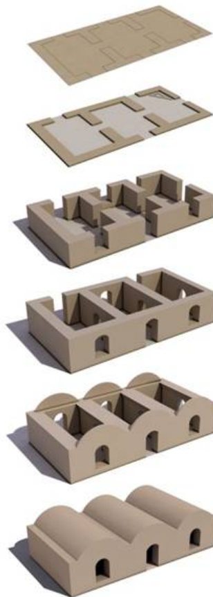
ت 10. مراحل اجرای خانه با تاق ضربی.
