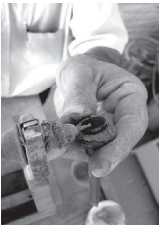
تصویر ۱۰ - چگونگی تماس نگین و تیغه الماسه در حکاکی با دستگاه عقیق‌کن، ماخذ: نگارندگان
