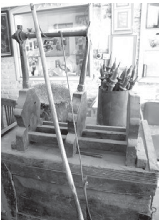
تصویر ۷- دستگاه عقیق‌کنی با لوازم جانبی، قدمت قاجاریه، مجموعه خاندان حمیدی حکاک شیرازی، ماخذ: نگارندگان
