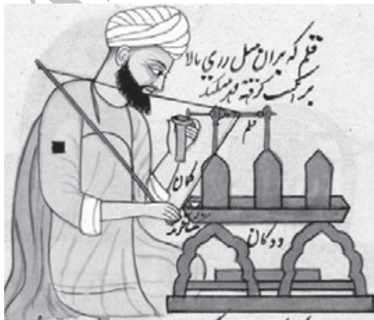
تصویر اب- برگی از نقاشی که یک حکاک کشمیری را در حال حکاکی کردن با دستگاه مخصوص حکاکی سنگ‌های قیمتی و نیمه قیمتی نشان می‌دهد، ماخذ: Gallop and Porter, 2010, 5
