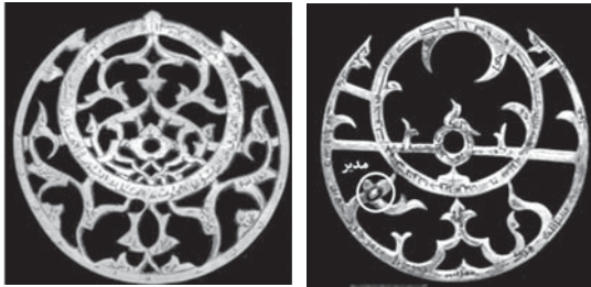
تصویر ۲۷ - عنكبوت اسطرلاب شمالی (راست) و عنكبوت اسطرلاب جنوبی (چپ)، ماخذ: همان
