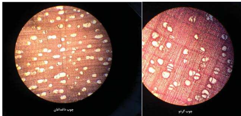
تصویر ۵. تصاویر میکروسکوپی از مقاطع عرضی نمونه‌های مورد آزمایش منبر نقوسان. مأخذ: نگارندگان.
