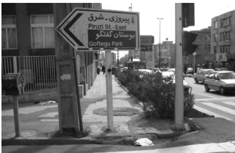
شکل ۳: عدم توجه به رفع موانع در مناسب‌سازی تقاطع‌ها
