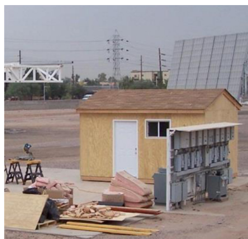
شکل ۱: مدل‌های تجربی ساخته شده همراه با PCM
