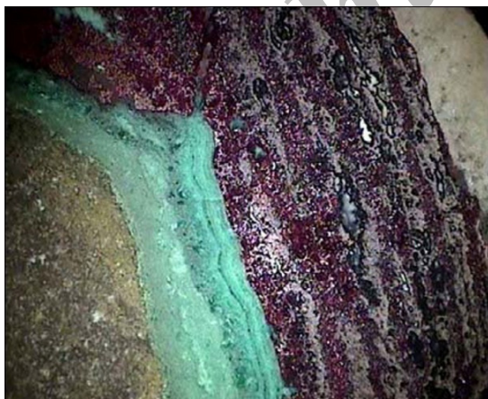
تصویر ۷. ریزساختار نمونه HT-50. ساختار لایه لایه در فاز کوپریت و تری‌هیدروکسی کلرید مس به خوبی قابل دیدن است. بزرگنمایی ۵۰ برابر.
