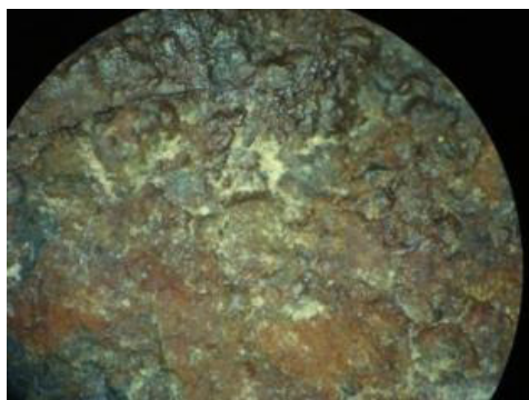
تصویر ۱۴. عکس میکروسکوپی از بست فلزی با بزرگ‌نمایی (100X) (نگارندگان).
