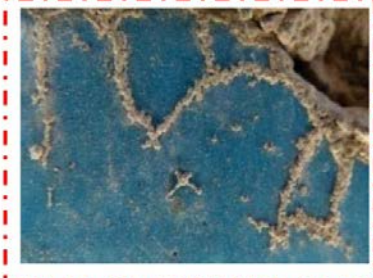
تصویر ۷. تبلور نمک در سطح ترک‌ها (نگارندگان).
