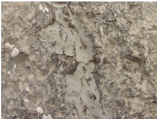
تصویر ۹. رزین استفاده شده برای مرمت در حال جدا شدن از سنگ (نگارندگان).
