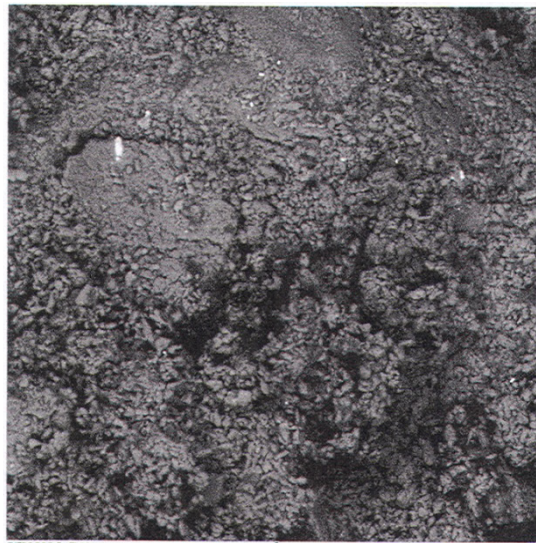
تصویر ۱۲. تصویر SEM نمونه 1/62. که هوازدگی و تخلخل در سطح سنگ دیده می‌شود (نگارندگان).
