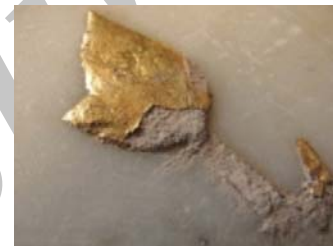
تصویر ۳۲. نمونه اجراشده در یک مرحله برای پیرسازی رطوبتی پس از پیرسازی (نگارندگان).
