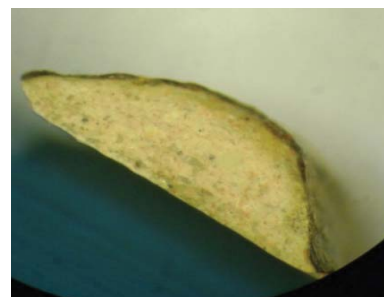
تصویر ۲۶. مقطع نمونه لایه‌چینی روی سنگ، تالار سوم شمس‌العماره با بزرگ‌نمایی ۴۰X (نگارندگان).
