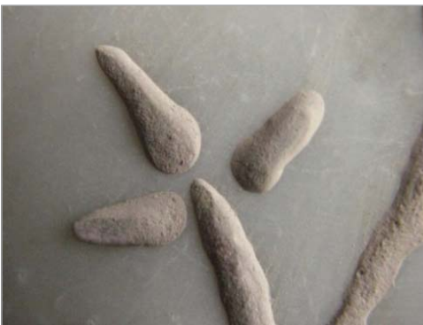
تصویر ۲۴. نمای نزدیک از نقوش اجراشده با نسبت سریش یک به سی (نگارندگان).
