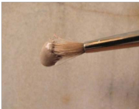
تصویر ۱۲. ترکیب لایه چینی با غلظت مناسب که شبیه به یک خمیر است (نگارندگان).
