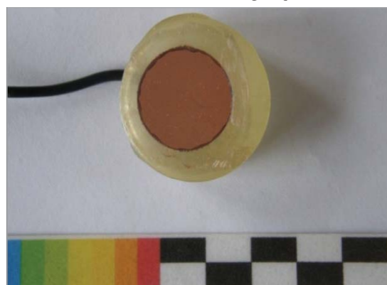
تصویر ۲. تفاوت در رنگ کوپریت بعد از غوطه‌وری در سیتریک اسید به مدت یک ساعت (نگارندگان).
