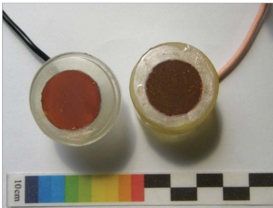
تصویر ۴. اختلاف رنگ لایه کوپریت بعد از غوطه‌وری در \text{Na}_4\text{-EDTA} (چپ) و \text{Na}_2\text{EDTA} (راست) به مدت یک ساعت (نگارندگان).
