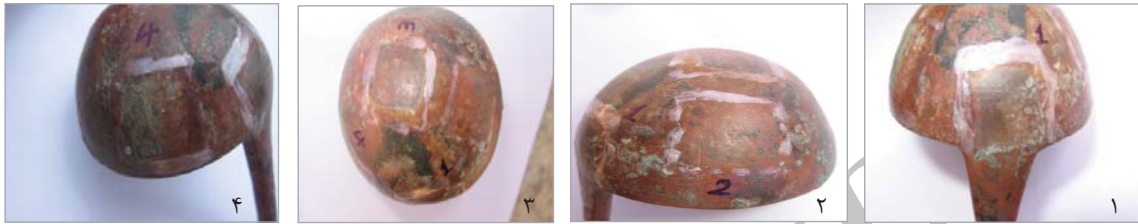
تصویر ۶. نمونه شیء تاریخی پس از تأثیر محلول‌های پاک‌سازی: ۱. سیتریک اسید، ۲. کالگون، ۳. \text{Na}_2\text{EDTA} ، ۴. نمک راشل قلیایی (نگارندگان).
