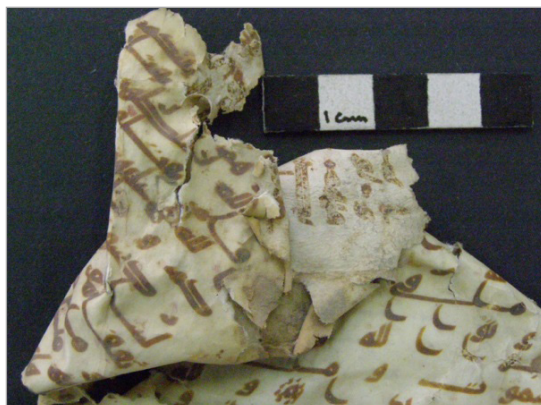
تصویر ۷. مجموعه‌ای از آسیب‌های فیزیکی و شیمیایی در سطح گوشتی پوست که شدیدتر از سطح مویی آن است (نگارندگان).
