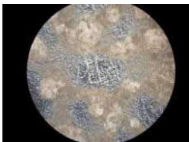
تصویر ۱۳. انباشتی مرکب به صورت توده‌های ضخیم روی کاغذ، نمونه S 1 ، با بزرگ‌نمایی ۳۰ برابر (نگارندگان)
