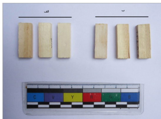
تصویر ۱. الف): تعدادی از نمونه‌های چوب شاهد بدون تیمار، ب): نمونه‌ها پس از تیمار با نانو کامپوزیت (نگارندگان)
