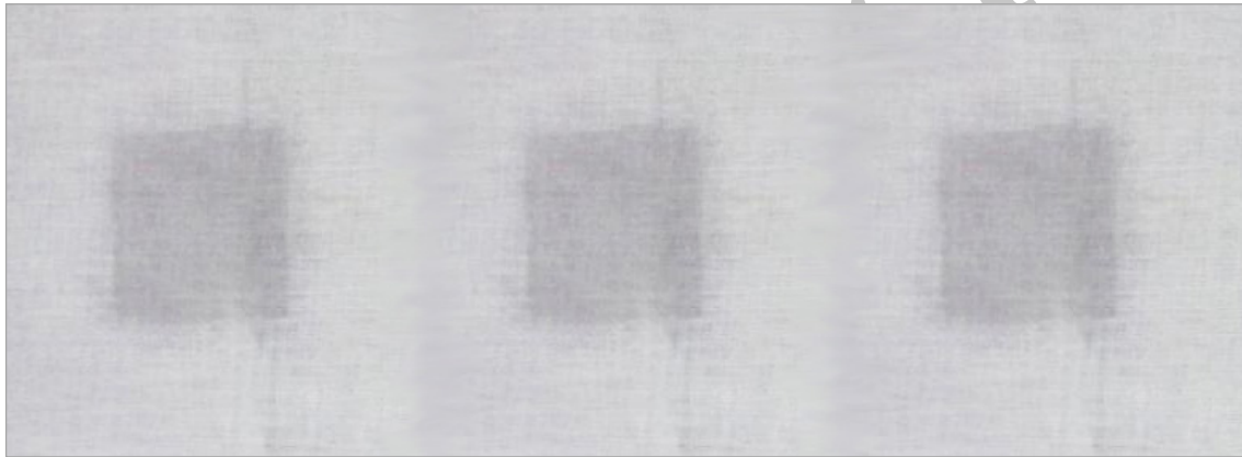
تصویر ۱. سه آلودگی به دست آمده با روش سیلک اسکرین تخت (نگارندگان)
