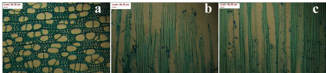
تصویر ۸. مقاطع میکروسکوپی نمونه قلعه دزدبند کرج: مقاطع عرضی (a)، مماسی (b) و شعاعی (c) (نگارندگان)
