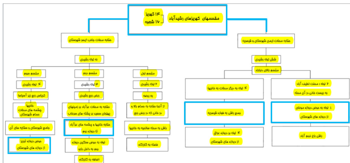
شکل ۱۱. نمودار کهریزهای رشیدآباد با ۱۶ لوله رشیدی شامل نام محلات و دروازه ها بر اساس متن وقفنامه (نگارندگان)
