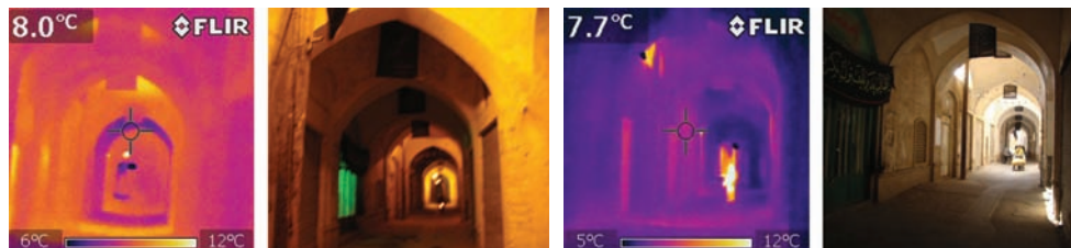
تصویر ۳۱: تعدیل نوسانات دمایی شبانه‌روزی در ساباطها در ظهر (راست) و شب (چپ) زمستان
