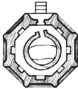
تصویر (۱۱): پلان مزار چلبی اوغلو، سلطانیه - دوره تیموری. در مزارهای جمالی - جلالی، فضای اطراف مقبره بسیار کوچک است و فضای چندانی جهت گردش زائر در نظر گرفته نشده است. (آرشیو دانشکده معماری دانشگاه علم و صنعت ایران، ۱۳۹۰)
